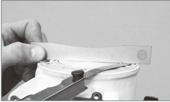
ピストンがプレートを押してシリンダーとプレートの接触が失われた場合
