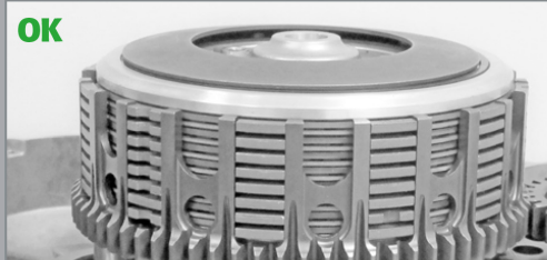
スプリングワッシャーの正しい取り付け方法の詳細
