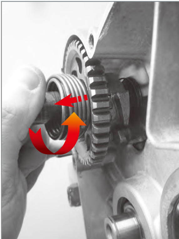
クランクケースからのシャフトの抜き取り
